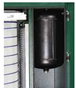
Calderín de aire comprimido para limpieza del filtro
