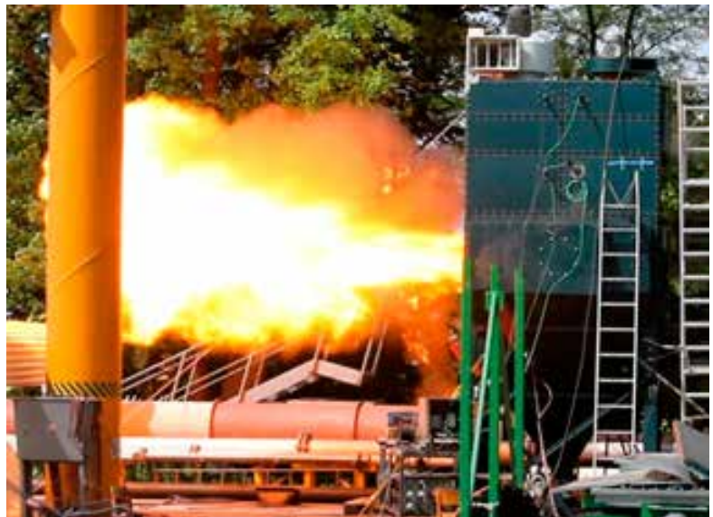
Una explosión en un colector de polvo puede causar la pérdida de vidas y serias lesiones.
