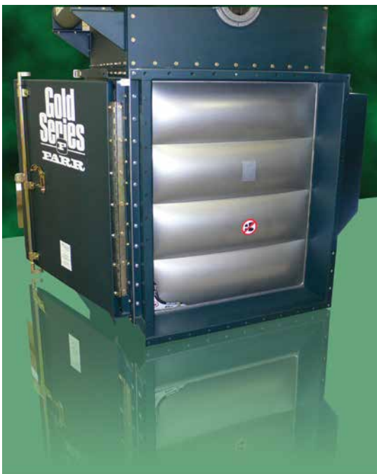
Diseñada para ser el eslabón "débil", la ventila anti-explósión se abre cuando las presiones predeterminadas se alcanzan al interior del colector de polvo, permitiendo a la sobrepresión y frentes de llama salir a una zona segura. Ventilas anti-explósión minimizan el daño al colector de polvo causado por exceso de presión creado por una deflagración.
